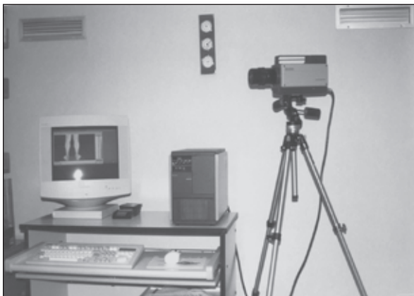
Figura 1. Sala y equipo de termografía: monitor, ordenador y cámara de vídeo.
