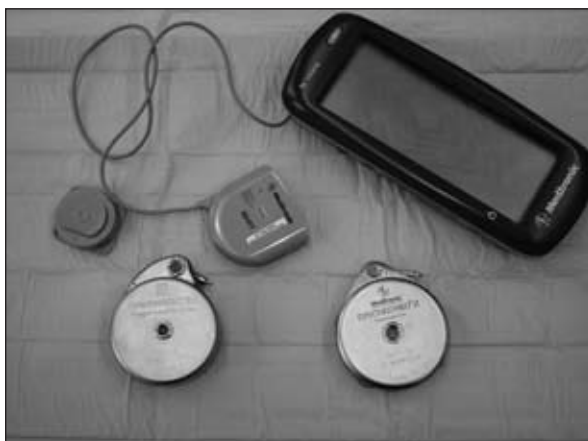
Figura 5. Dispositivos de perfusão intratecal e programador.
