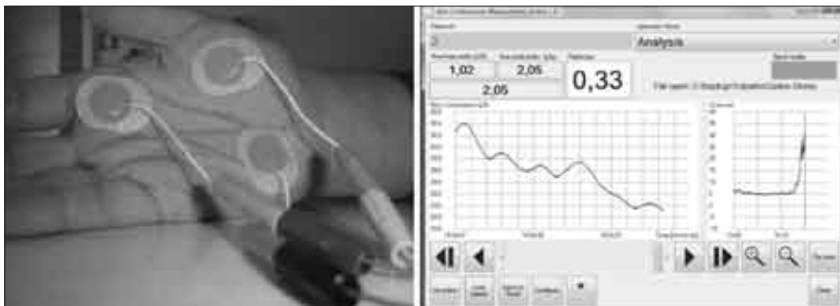
Figura 1. À esquerda, representação da aplicação dos eléctrodos de recolha do sinal da condutância da pele (preto: M, measurement, azul: R, referência, amarelo: C, current); à direita, software de recolha e tratamento de dados, com a apresentação da onda de condutância em tempo real e índices obtidos pelo processamento da onda de condutância (area small peaks, area huge peaks, peaks/s).
